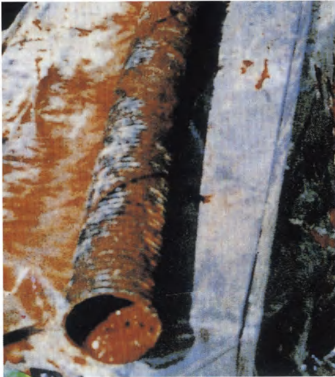
酸化鉄、植物性繊維が沈着して目詰まりをおこした化学製品。
