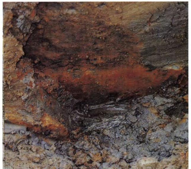
暗渠効果によるグライ層の変化
